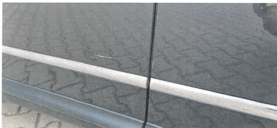
Porysowane drzwi z prawej strony
