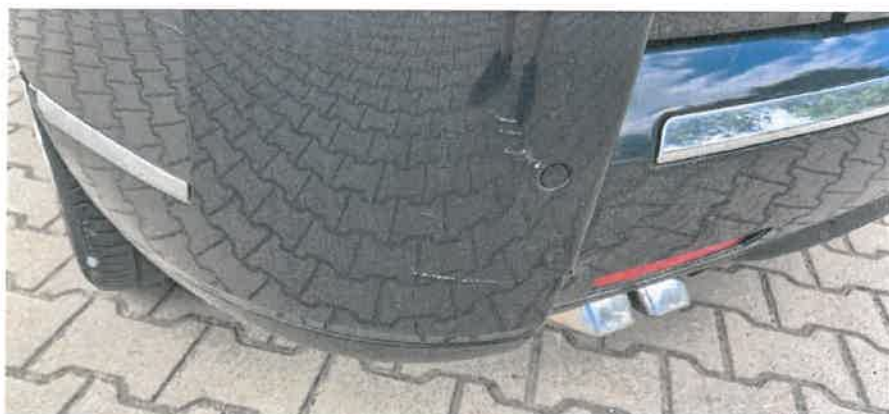
Porysowany tylny zderzak z lewej strony
