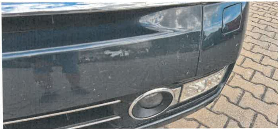
Porysowany przedni zderzak z lewej strony
