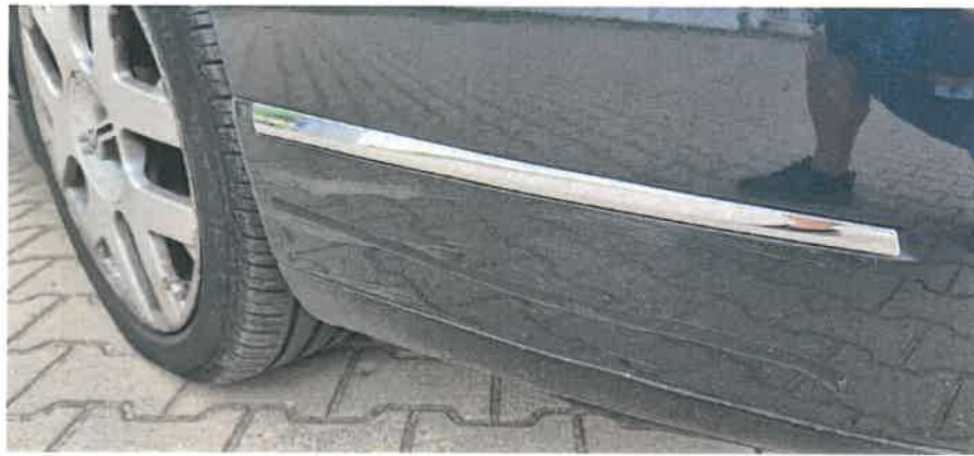
Porysowane prawe tylne drzwi
