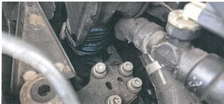
Wycieki oleju z silnika – do weryfikacji w A.S.O Citroen
