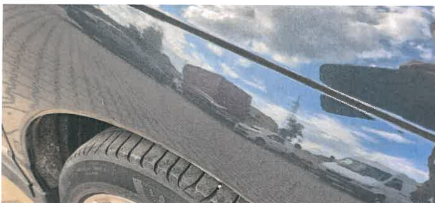
Porysowany tylny błotnik z lewej strony
