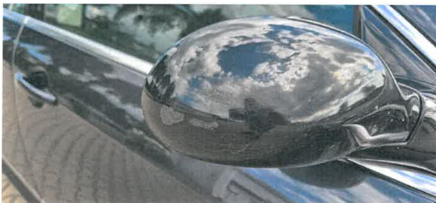
Porysowana obudowa prawego lusterka
