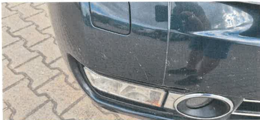
Porysowany przedni zderzak z prawej strony
