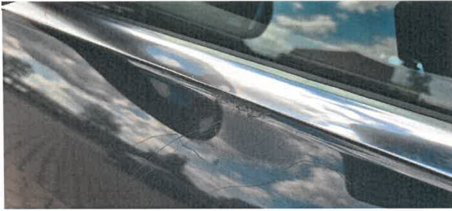
Porysowane drzwi kierowcy w górnej części
