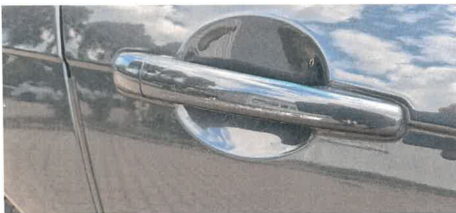
Porysowana klamka drzwi tylnych z prawej strony
