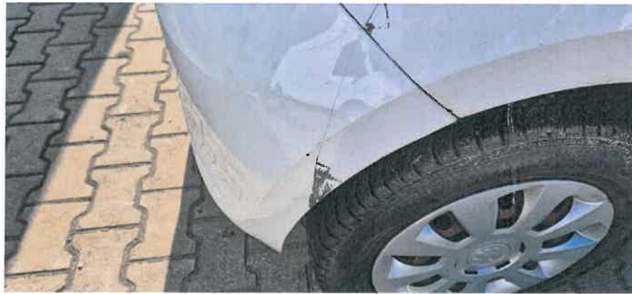
Porysowany i pęknięty tylny zderzak z prawej strony
