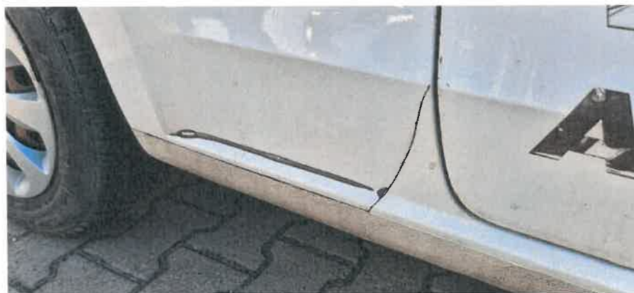
Porysowana i wgnieciona prawa ściana kabiny
