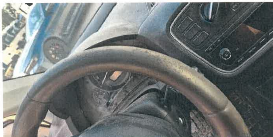
Wytarte koło kierownicze
