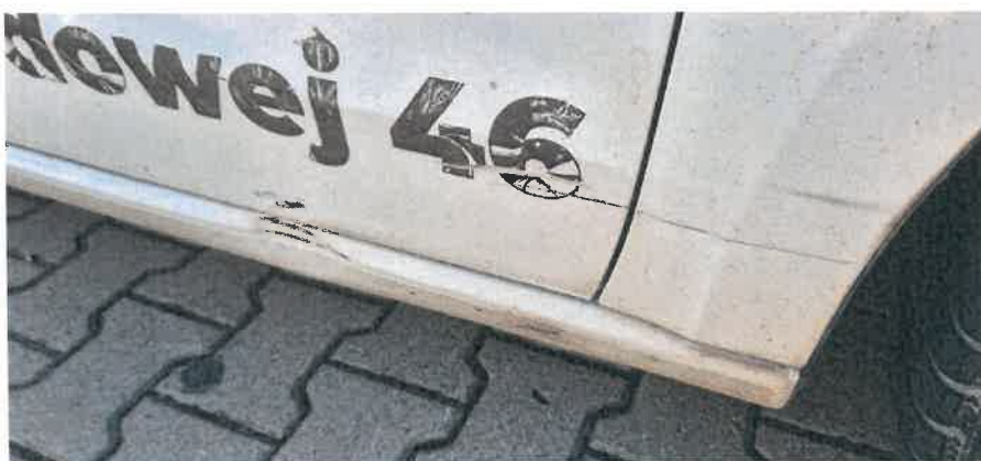
Porysowany próg, drzwi oraz nadkole z prawej strony
