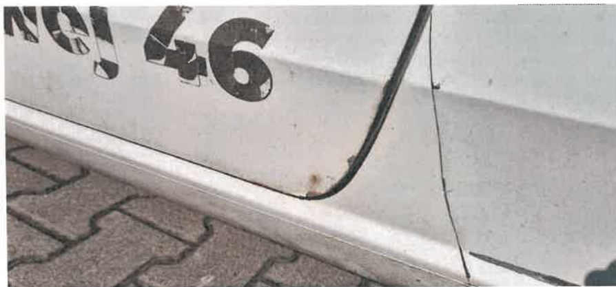
Porysowane i pogięte lewe drzwi
