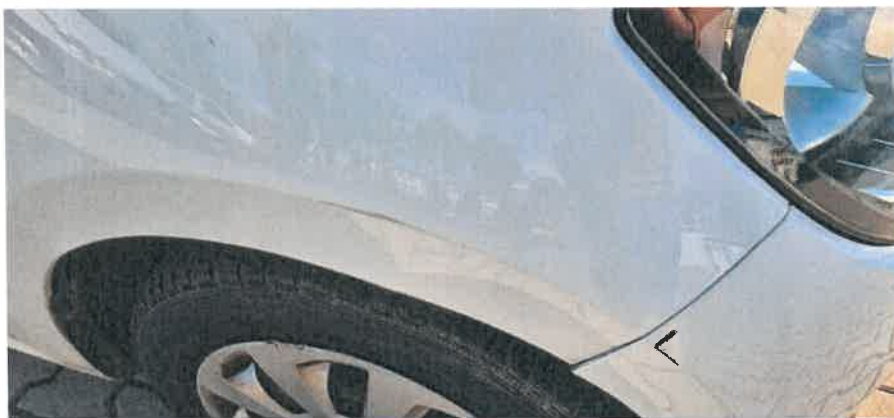
Porysowane prawe przednie nadkole
