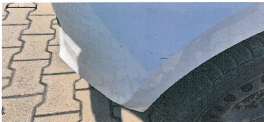
Porysowany przedni zderzak z lewej strony
