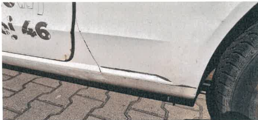
Porysowana i wgnieciona lewa ściana kabiny
