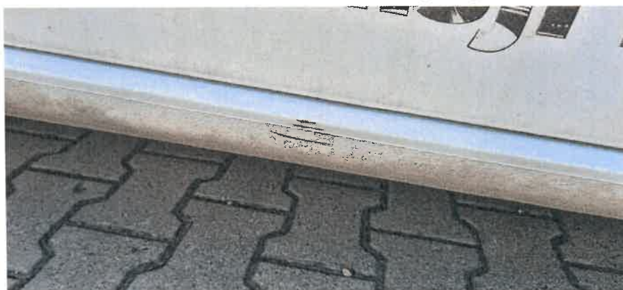
Porysowany i pocięty próg z prawej strony w środkowej części
