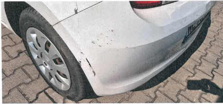
Porysowany tylny zderzak oraz błotnik z lewej strony
