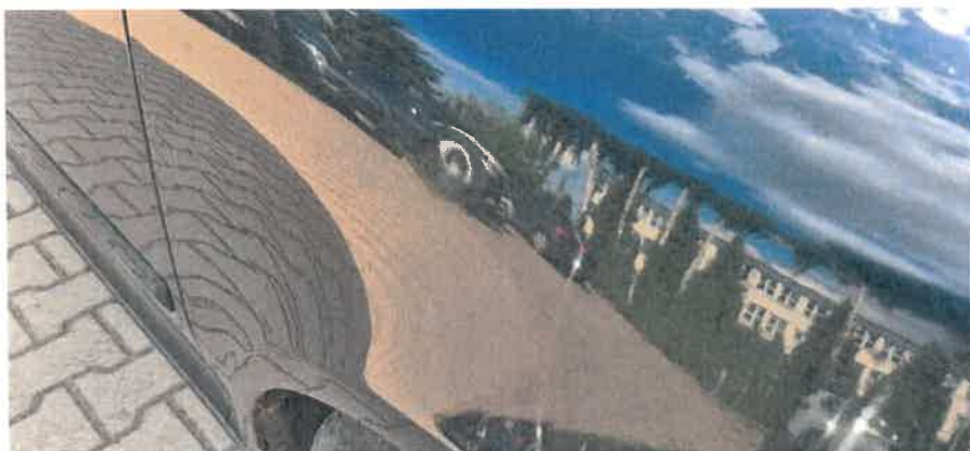
Porysowany i wgnieciony przedni błotnik z prawej strony
