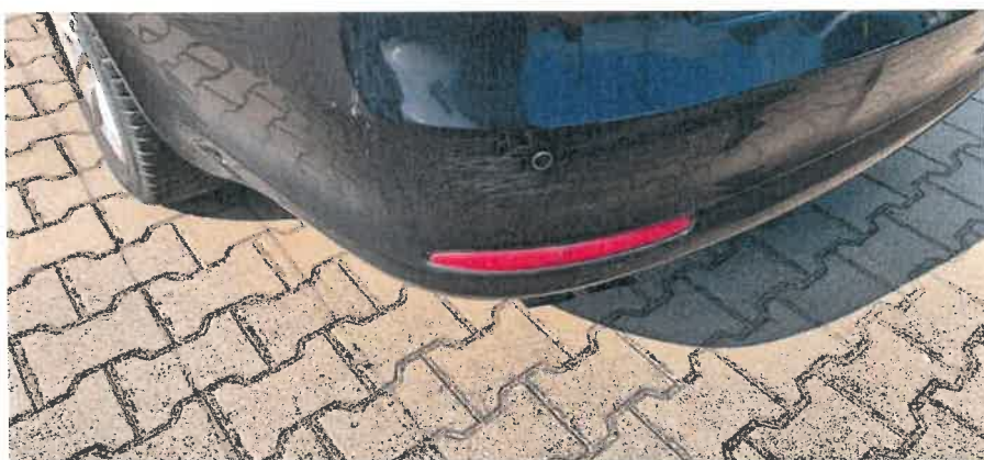
Porysowany tylny zderzak z lewej strony
