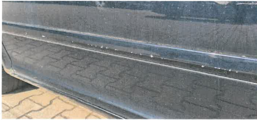
Odpryski lakieru na lewych przednich drzwiach
