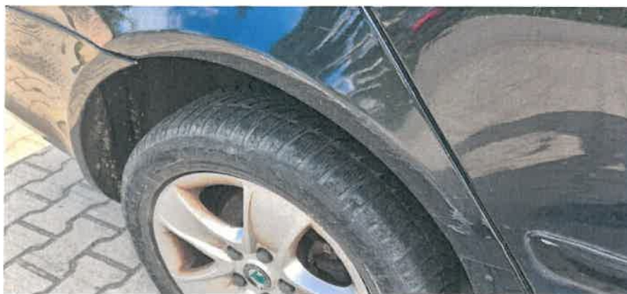
Porysowany i wgnieciony tylny błotnik z prawej strony
